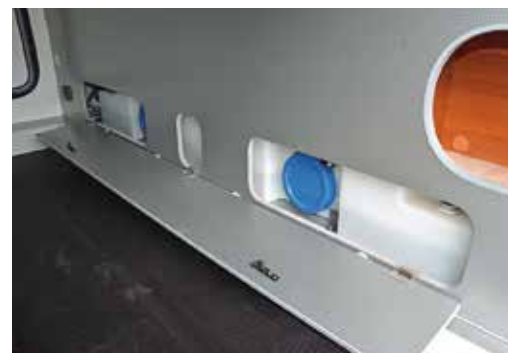
Der Frischwassertank ist über eine Klappe in der zweitürigen Heckgarage gut zu erreichen.
