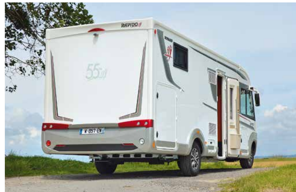
55 Jahre Rapido: Der neue 8096DF erweist sich als würdiges Jubiläumsmodell. Gut zu erkennen: Das verzinkte Chassis von Al-Ko, auf das Rapido den Doppelboden setzt.
