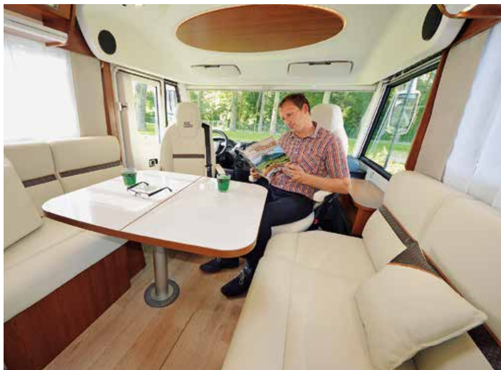
Schnell umgebaut und auch für längere Strecken tauglich: Aus den beiden Längs-Sofas entsteht jeweils ein Einzelsitz mit höhenverstellbarer Kopfstütze und Dreipunktgurt.
