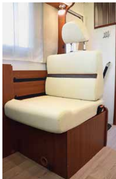
Schnell umgebaut und auch für längere Strecken tauglich: Aus den beiden Längs-Sofas entsteht jeweils ein Einzelsitz mit höhenverstellbarer Kopfstütze und Dreipunktgurt.
